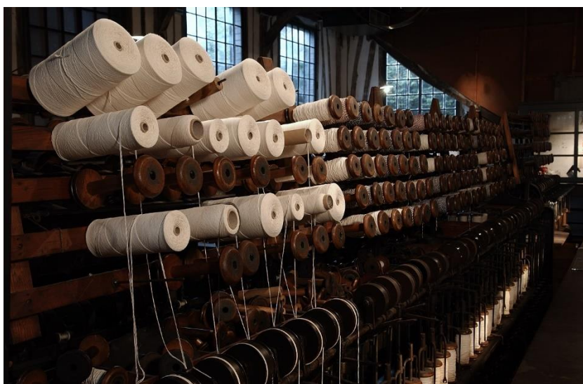
Retordeuse à ailettes. J. & T. Boyd Makers, Glasgow, 1920. Machine constituée d'un bâti en fonte et de 35 ailettes Musée Industriel de la Corderie Vallois Notre-Dame de Bondeville
